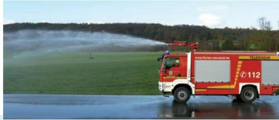
Das Gesamtgewicht von rund 18 Tonnen und die Abmessungen von 8 Metern Länge, einer Breite von 2,5 m und 3,3 Meter Höhe verlangen den Maschinisten volle Konzentration ab, um das Fahrzeug sicher durch den Verkehr zu bewegen. Etwas Entlastung für die Fahrer, gerade bei Alarmfahrten, lie-
