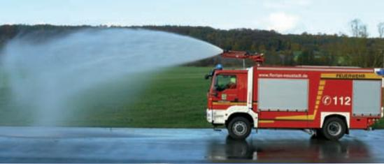
eingestellt werden. Die fest im Fahrzeugheck eingebaute Feuerlöschkreiselpumpe kann bis zu 3000 Liter pro Minute bei 10 bar Druck fördern. Die Schaummittelzumischpumpe sorgt dafür, dass Konzentrat und Wasser im richtigen Verhältnis vermischt werden und Löschschaum fix und fertig abgegeben werden kann.
